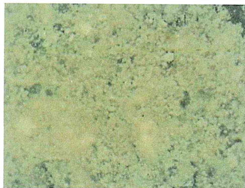
Εικόνα 14: Γενική εικόνα δείγματος 2 σε μεγαλύτερη μεγέθυνση, εμφανή ανοιχτόχρωμα αδρανή (x50)
