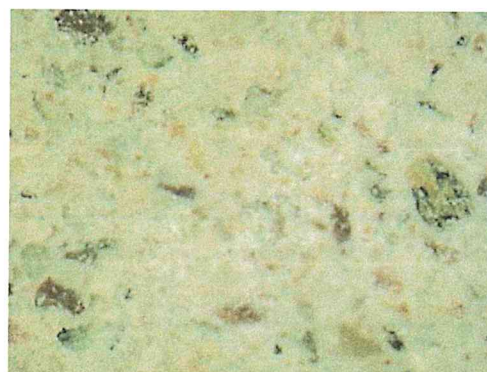
Εικόνα 16: Παρουσία αδρανών διαφόρων μεγεθών και αποχρώσεων στο 3 (x50)
