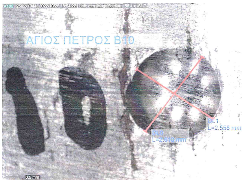
Εικόνα 10. Ενδεικτική εικόνα εύρεσης εγκλεισμάτων.
