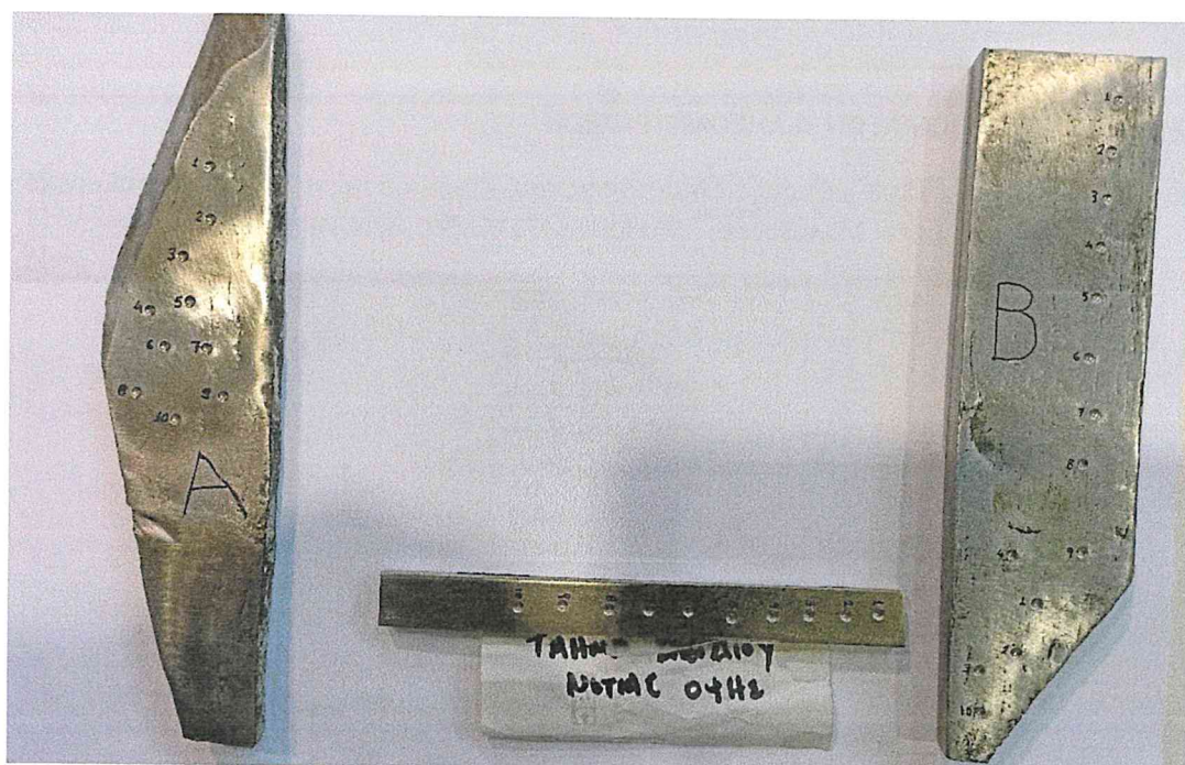
Εικόνα 6. Τα χαλύβδινα δοκίμια μετά τις σκληρομετρήσεις.
