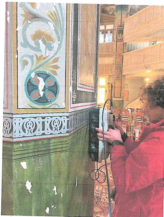
Εικόνα 2.4: Φωτογραφία του συστήματος γεωραντάρ κατά τη διάρκεια γεωφυσικών διασκοπήσεων. Ο εξοπλισμός που φαίνεται στη φωτογραφία αποτελείται από: - Μονάδα Ελέγχου GX, - θωρακισμένη κεραία κεντρικής συχνότητας 750 MHz, - οθόνη XV11.
