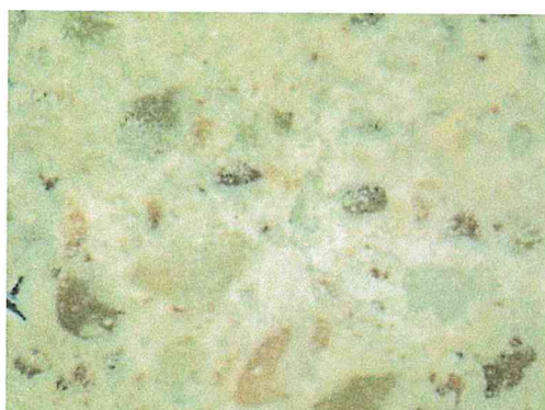
Εικόνα 17: Παρουσία αδρανών αποστρογγυλεμένης αλλά και πιο γωνιώδους γεωμετρίας στο 3 (x50)
