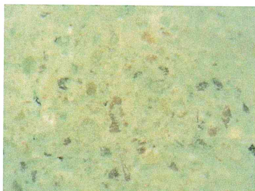
Εικόνα 15: Γενική εικόνα δείγματος 3 και εμφανής παρουσία αδρανών διαφόρων αποχρώσεων (x30)
