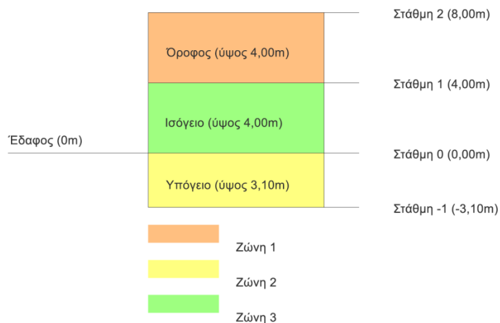
Εικόνα 4 Σχηματική τομή επιπέδων κτιρίου
