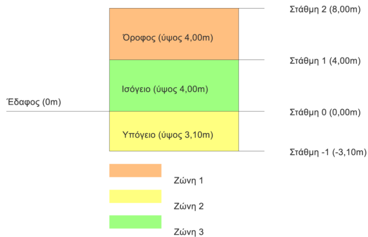
Εικόνα 4 Σχηματική τομή επιπέδων κτιρίου
