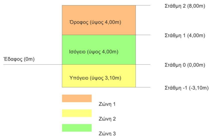
Εικόνα 4 Σχηματική τομή επιπέδων κτιρίου
