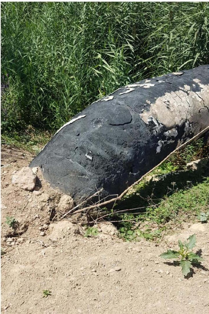
Εικ. 4. Καθίζηση και βλάβη σε Φ800
