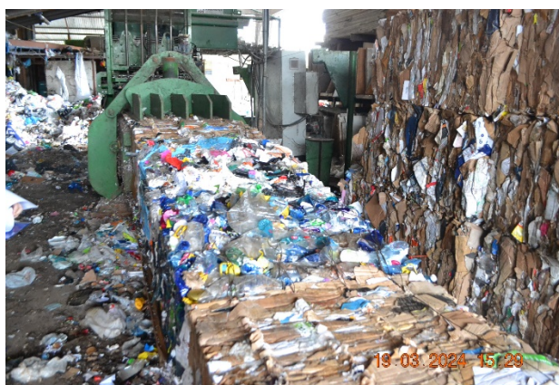
Τοποθέτηση των αποβλήτων ανά κατηγορία σε τελάρα όπου μετά από πρέσα πραγματοποιείται η δεματοποίησή τους ανά είδος
