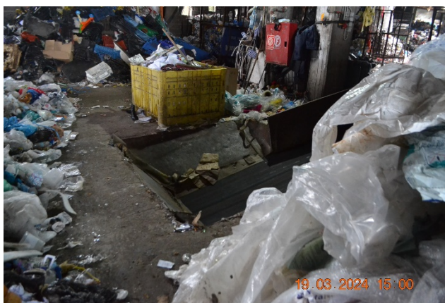
Χειροδιαλογή των ογκωδών ανακυκλώσιμων και τοποθέτηση των μικρότερων αποβλήτων στον ταινιόδρομο
