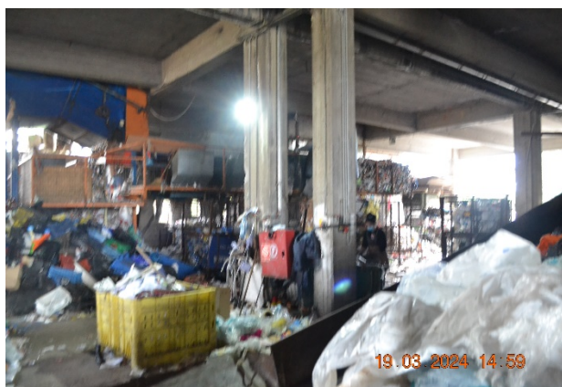
Χειροδιαλογή των ογκωδών ανακυκλώσιμων και τοποθέτηση των μικρότερων αποβλήτων στον ταινιόδρομο
