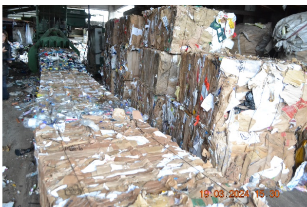
Τοποθέτηση των αποβλήτων ανά κατηγορία σε τελάρα όπου μετά από πρέσα πραγματοποιείται η δεματοποίησή τους ανά είδος
