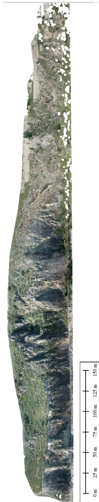
Εικόνα 3.25. Ορθο-φωτο-μωσαϊκό του Νότιου προφίλ που προκύπτει από συνδυαστική επεξεργασία των δεδομένων που ελήφθησαν από πτήσεις κάθετα στο πρανές και οριζόντια.
