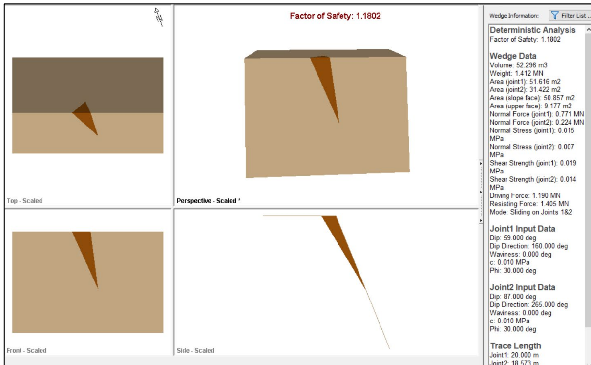
Εικόνα 5.5. Σκαρίφημα τμήματος NO με πιθανή αποκόλληση σφήνας σε στατικές συνθήκες
