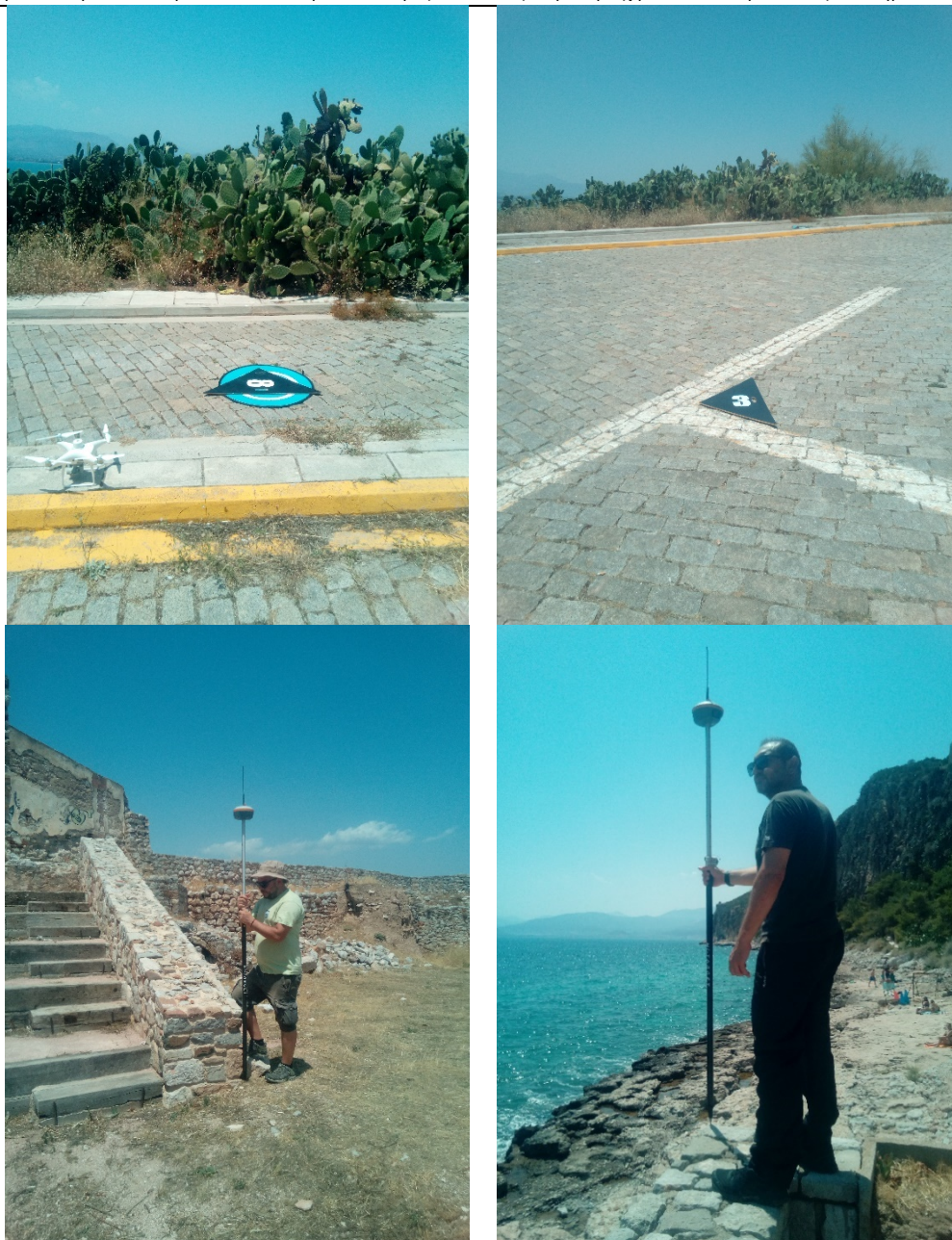
Εικόνα 3.2. Ίδρυση σημείων ελέγχου με εξοπλισμό RTK-GNSS, μεγάλης ακρίβειας.
