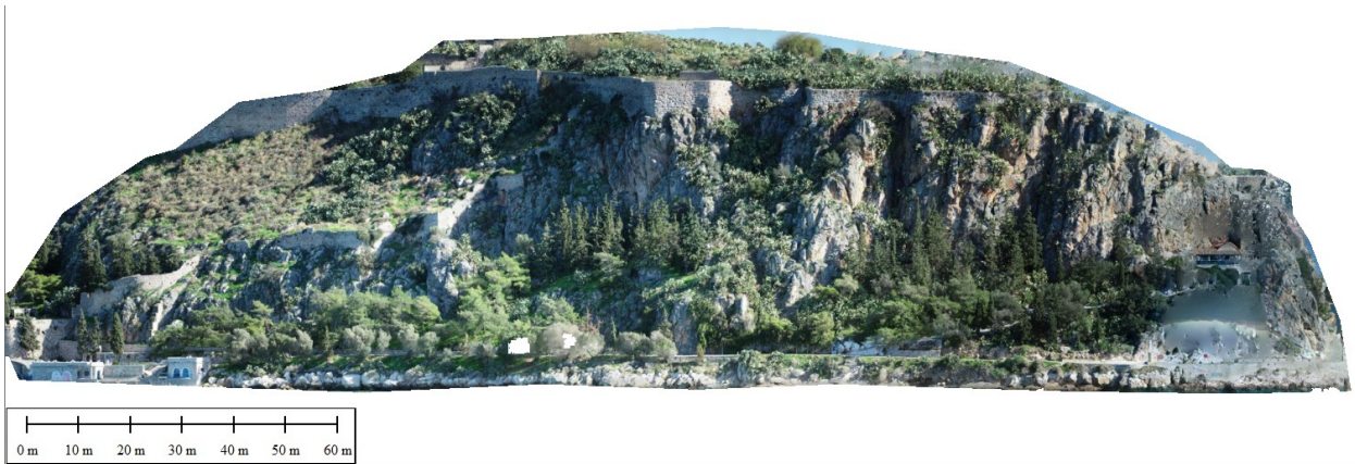
Εικόνα 3.15. Ορθο-φωτο-μωσαϊκό του Βόρειου Προφίλ που προκύπτει από την επεξεργασία των δεδομένων που ελήφθησαν από πτήσεις κάθετα στο πρανές.
