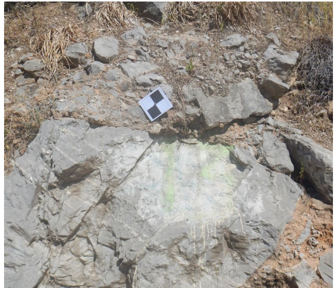
Εικόνα 3.1. Ίδρυση τοπογραφικών βάσεων και στόχων με εξοπλισμό Total Station, εξαιρετικά μεγάλης ακρίβειας.
